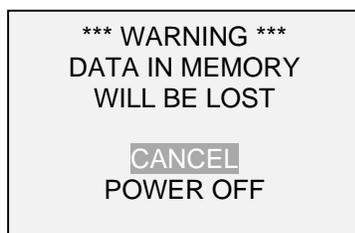
Si aucune option n'est sélectionnée, cet écran s'affiche indéfiniment ou jusqu'à la décharge complète de la pile.
