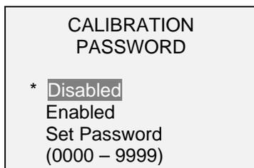
Pour configurer le mot de passe, sélectionnez **Enabled** (Activé), puis **Set password** (Configurer le mot de passe). Utilisez les touches et pour augmenter ou diminuer la valeur, de 0 à 9 999. Après avoir sélectionné la valeur voulue, appuyez sur **ENTER** (Entrée), puis sur **ESCAPE** (Échap.) pour quitter le sous-menu.
