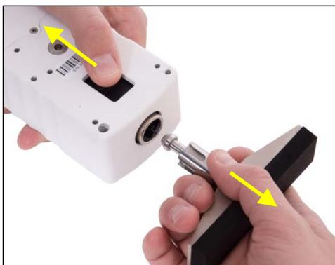
Si l'adaptateur de poignée E1011 (illustré ci-dessous) est utilisé, les poignées et les fixations communes peuvent être montées à l'aide du filetage 5/16-18F intégré.
