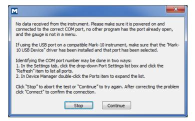
Este mensaje aparece después de haber pulsado **START** (Comenzar) si no se ha logrado establecer comunicación entre el instrumento y el software, debido a una serie de causas posibles. Si no puede establecer comunicación siguiendo estas instrucciones, intente con un puerto USB/COM diferente o un PC diferente.
