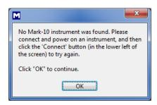
Si el instrumento está correctamente conectado y configurado, pero el mensaje sigue apareciendo, la conexión del puerto COM se puede configurar de forma manual. Consulte el organigrama de comunicación que aparece a continuación y las siguientes secciones para obtener información más detallada.
