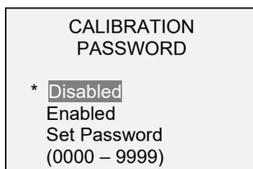
Um das Passwort zu setzen, wählen Sie **Enabled** und anschließend **Set Password**. Mit den Tasten **UP** und **DOWN** können Sie die Werte erhöhen bzw. verringern (von 0 bis 9999). Wenn der gewünschte Wert ausgewählt wurde, drücken Sie **ENTER** und anschließen **ESC**, um das Untermenü zu verlassen.
