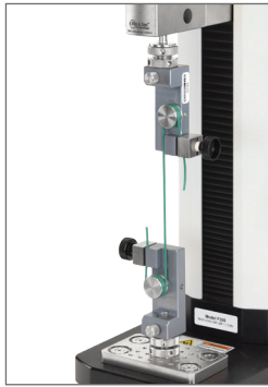
Wire tensile testing
